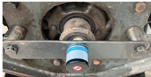
Hình 4: Vị trí lắp Encoder thu tín hiệu tốc độ động cơ
