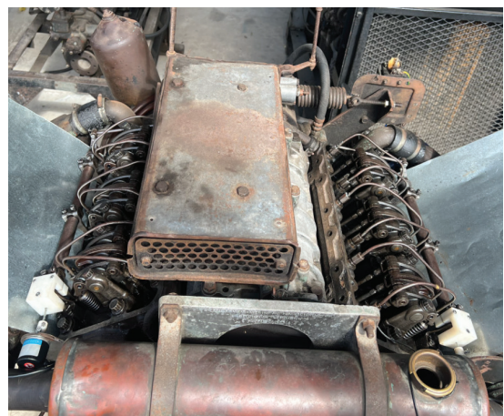
Hình 8: Động cơ thực nghiệm Detroit Diesel 6V53
