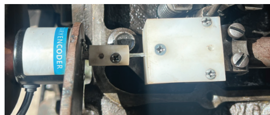
Hình 5: Vị trí lắp Encoder thu tín hiệu dịch chuyển thanh nhiên liệu trái
