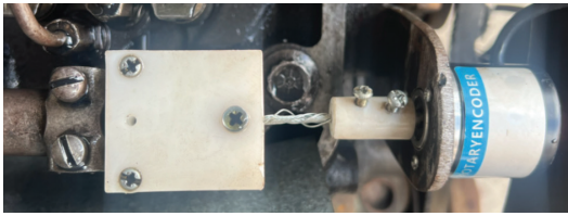
Hình 6: Vị trí lắp Encoder thu tín hiệu dịch chuyển thanh nhiên liệu phải
