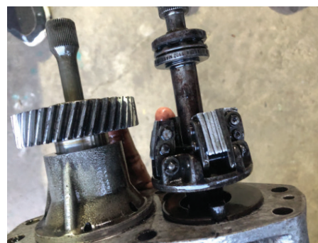
Hình 2: Các bộ phận của bộ điều tốc đa chế độ trên động cơ Diesel 6V53
