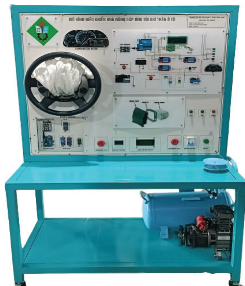
Hình 6. Mô hình điều khiển khả năng đáp ứng túi khí trên ô tô.
