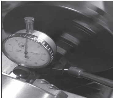
Hình 2. Đo độ lệch trục bằng đồng hồ so
