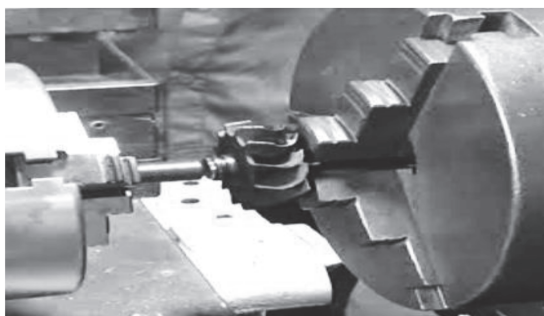
Hình 8. Gá kẹp phôi chuẩn bị hàn
