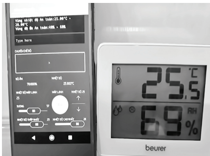
Hình 8: Nhiệt độ và độ ẩm hiển thị trên điện thoại so với nhiệt ẩm kế tại nhiệt độ 25,5°C và độ ẩm 69% (thông số trên điện thoại hiển thị nhiệt độ 25,8°C và ẩm độ 70%)
