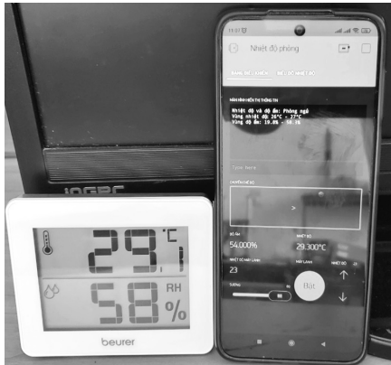
Hình 7: So sánh giữa thiết bị và Nhiệt ẩm kế Beurer HM16 tại nhiệt độ 29°C và độ ẩm 58% (thông số trên điện thoại hiển thị nhiệt độ 29,3°C và ẩm độ 54%)
