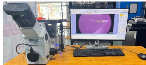
Máy đo mòn dao - Camera kính hiển vi Olympus GX51
