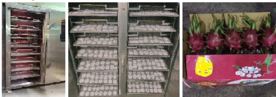
Hình 3. Hệ thống sấy bơm nhiệt kết hợp hồng ngoại sử dụng trong thực nghiệm
