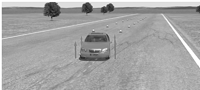
Hình 10. Hình ảnh mô phỏng ở vận tốc 30 km/h và hệ số bám 0.1
